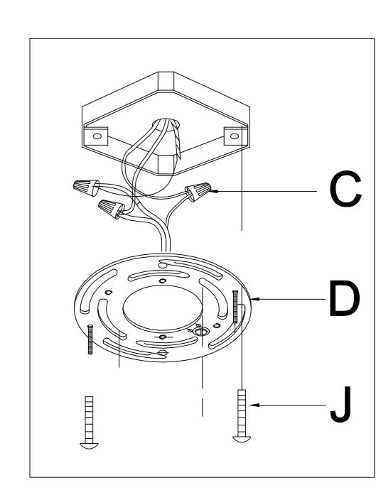
NEVER CONNECT GROUND WIRE TO BLACK OR WHITE POWER SUPPLY WIRES.
