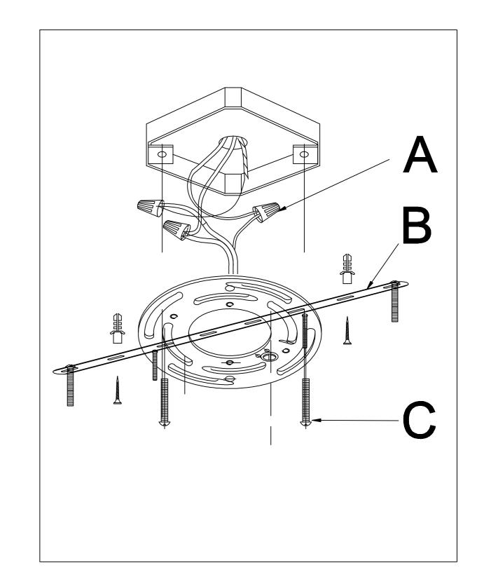
NEVER CONNECT GROUND WIRE TO BLACK OR WHITE POWER SUPPLY WIRES.
