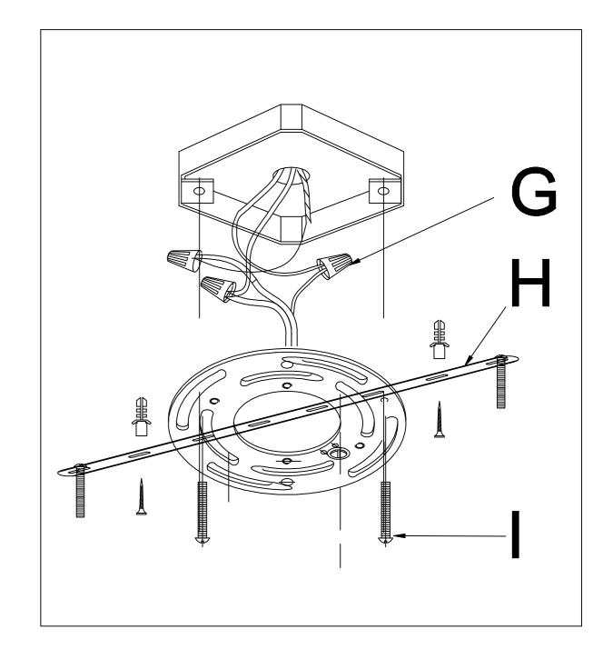
NEVER CONNECT GROUND WIRE TO BLACK OR WHITE POWER SUPPLY WIRES.
